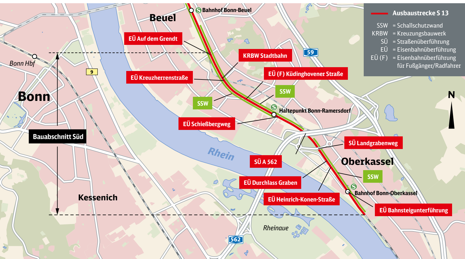
Der südliche Bauabschnitt
