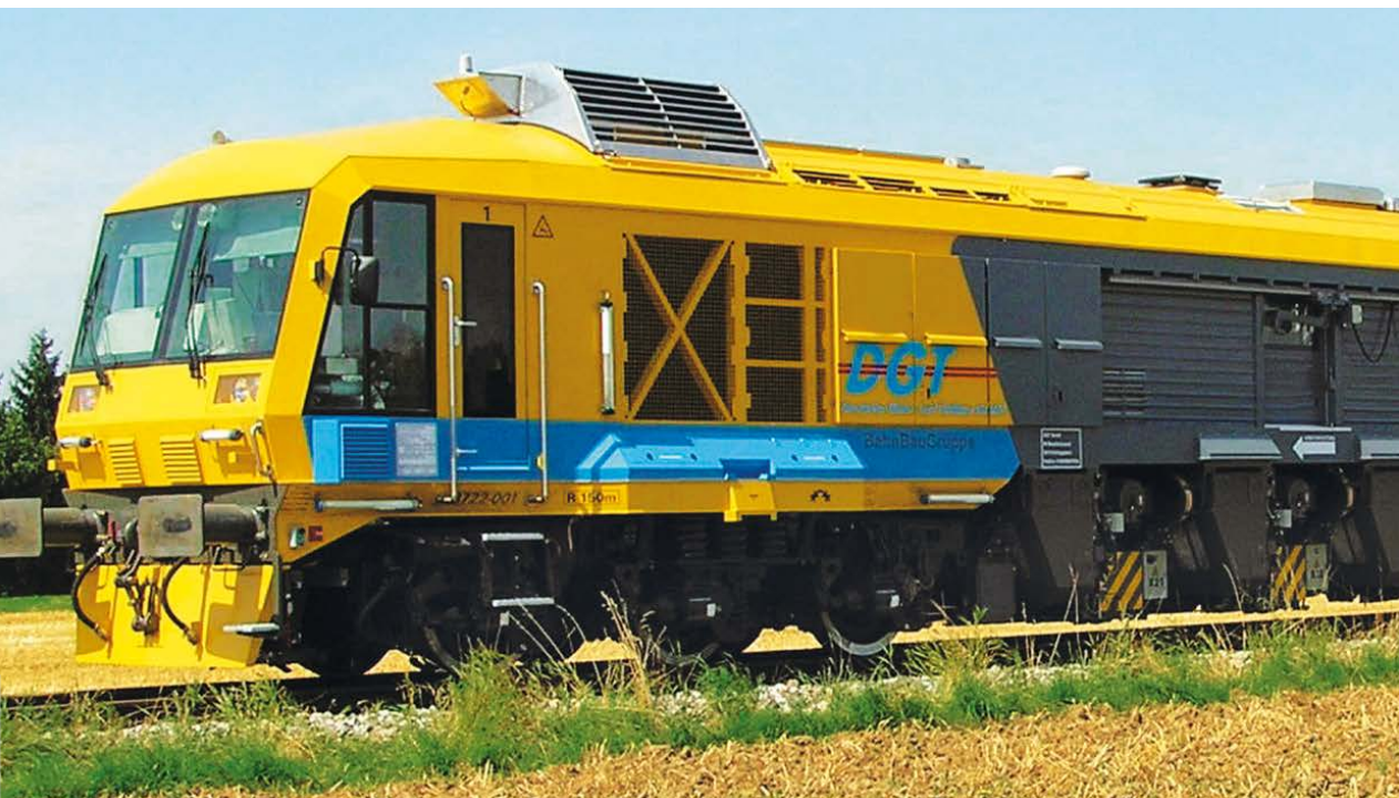
Schienenschleifzug beim Besonders überwachten Gleis
