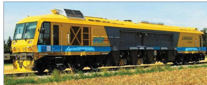
Schienenschleifzug beim Besonders überwachten Gleis
