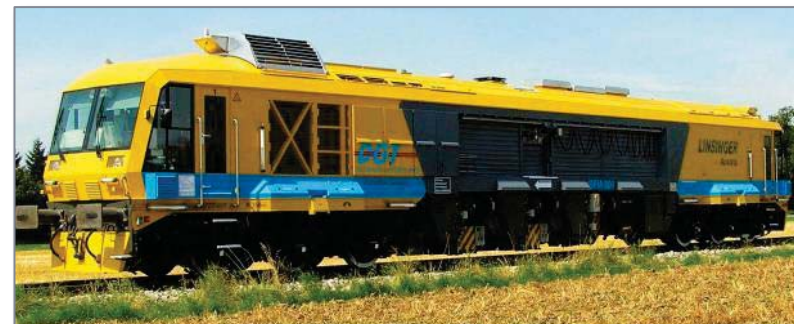
Schienenschleifzug beim Besonders überwachten Gleis
