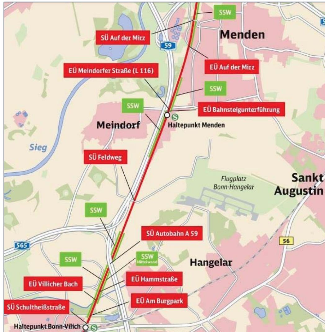
Schallschutzwände im PFA 2 – Bereich Sankt Augustin
