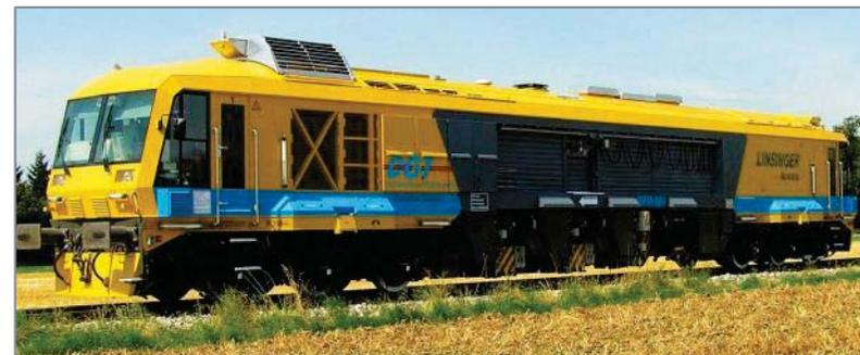
Schienenschleifzug beim Besonders überwachten Gleis
